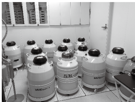
図1 ロードセル（重量計）に設置した凍結容器
